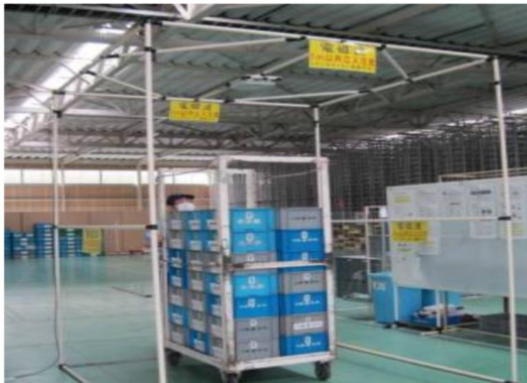
図表6. 6. 実験装置 (RFID読取り装置)
