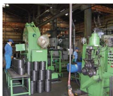
ベンダ工業のリングギアは材料廃棄率が低い工法で作られている
