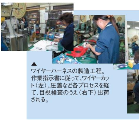
ワイヤーハーネスの製造工程。作業指示書に従って、ワイヤーカット(左)、圧着など各プロセスを経て、目視検査のうえ(右下)出荷される。
