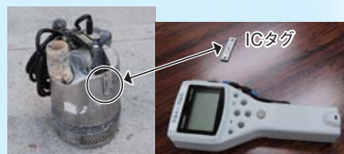
2009年に導入したICタグによるレンタル機械管理システム。
